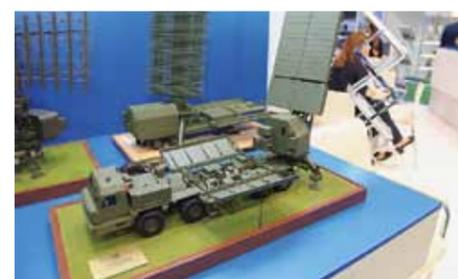
работает при любой погоде (от -55 до +55°C), при влажности до 98%. Согласно новой российской концепции единого поля, станция типа 1Л122Е относится к радарам «в засаде». Эта МРЛС используется также для наведения ракет на завершающем участке траектории в условиях интенсивного радиоэлектронного противодействия. Станция эффективна в том числе в работе против высокоточного оружия.
