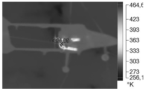
Рисунок 4. – Вид термограммы с ракурса азимут 90°, угол места 36° при работе ДВС на взлетном режиме
