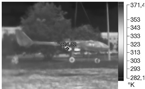
Рисунок 3. – Вид термограммы с ракурса азимут 90°, угол места 36° на номинальном режиме работы ДВС
