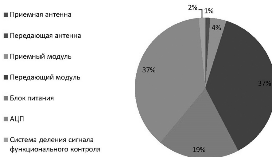
Рисунок 2. – Диаграмма тепловыделений функциональных модулей приёмопередатчика
