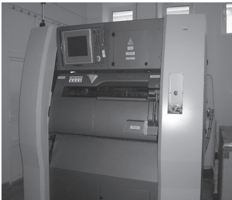
Рисунок 3. – Металлургический 3D-принтер ProX DMP 300
