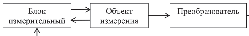
Рисунок 1. – Схема подключения объекта измерений к анализатору
